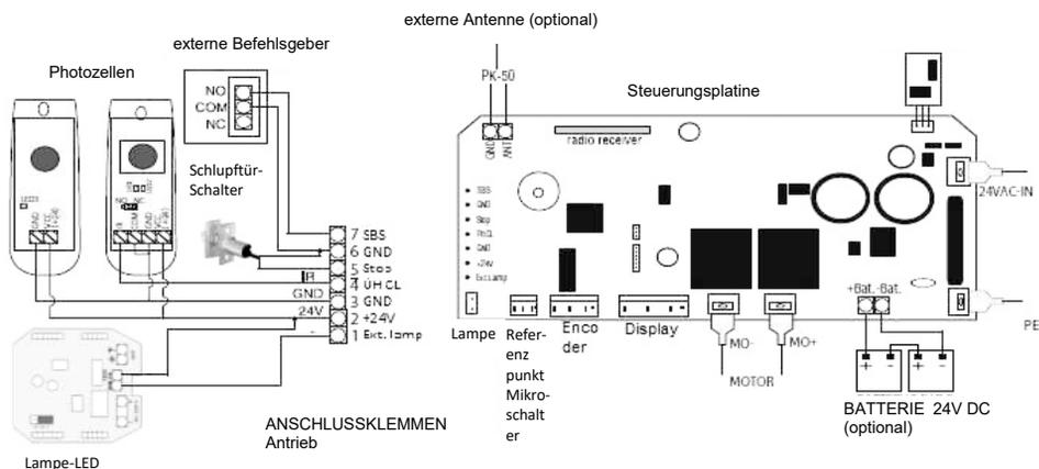
Für die Anschlussarbeiten, kann die Klemmreihe vom Sockel abgezogen und nach der Verkabelung wieder eingesteckt werden.
