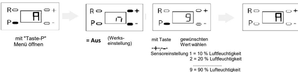
**Verlassen des Programmiermodus über drücken der "R-Taste", bis "0" erscheint. Dies ist von jedem Menüpunkt aus möglich**
