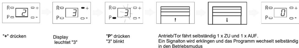
Der Antrieb ist jetzt für den Standardbetrieb arbeitsbereit. Sollten Zusatzeinstellungen gewünscht werden, ist die Programmierenebene erneut durch drücken der Taste "P" zu öffnen.
