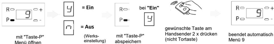
Bei Aktivierung der internen Beleuchtung wird mittels drücken der anlernten Handsendertaste die internen LED-Lampe ein- bzw. ausgeschaltet und bietet so eine Notbeleuchtung, ohne den Antrieb in Bewegung zu setzen. Das Licht **erlöscht hierbei jedoch nicht automatisch und muss durch ernetutes drücken der Handsendertaste, ausgeschaltet werden.**
